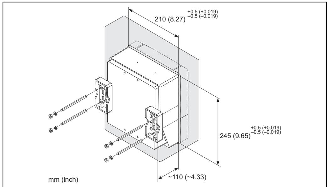
图 65: 盘式安装示意图 ( 墙装型外壳 )
