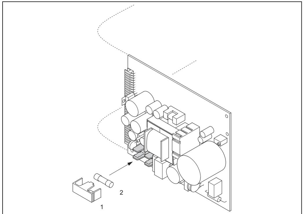
图 91: 更换电源板上的设备保险丝
