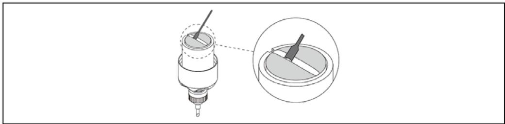
图 40: 在传感器接触表面涂上耦合剂
