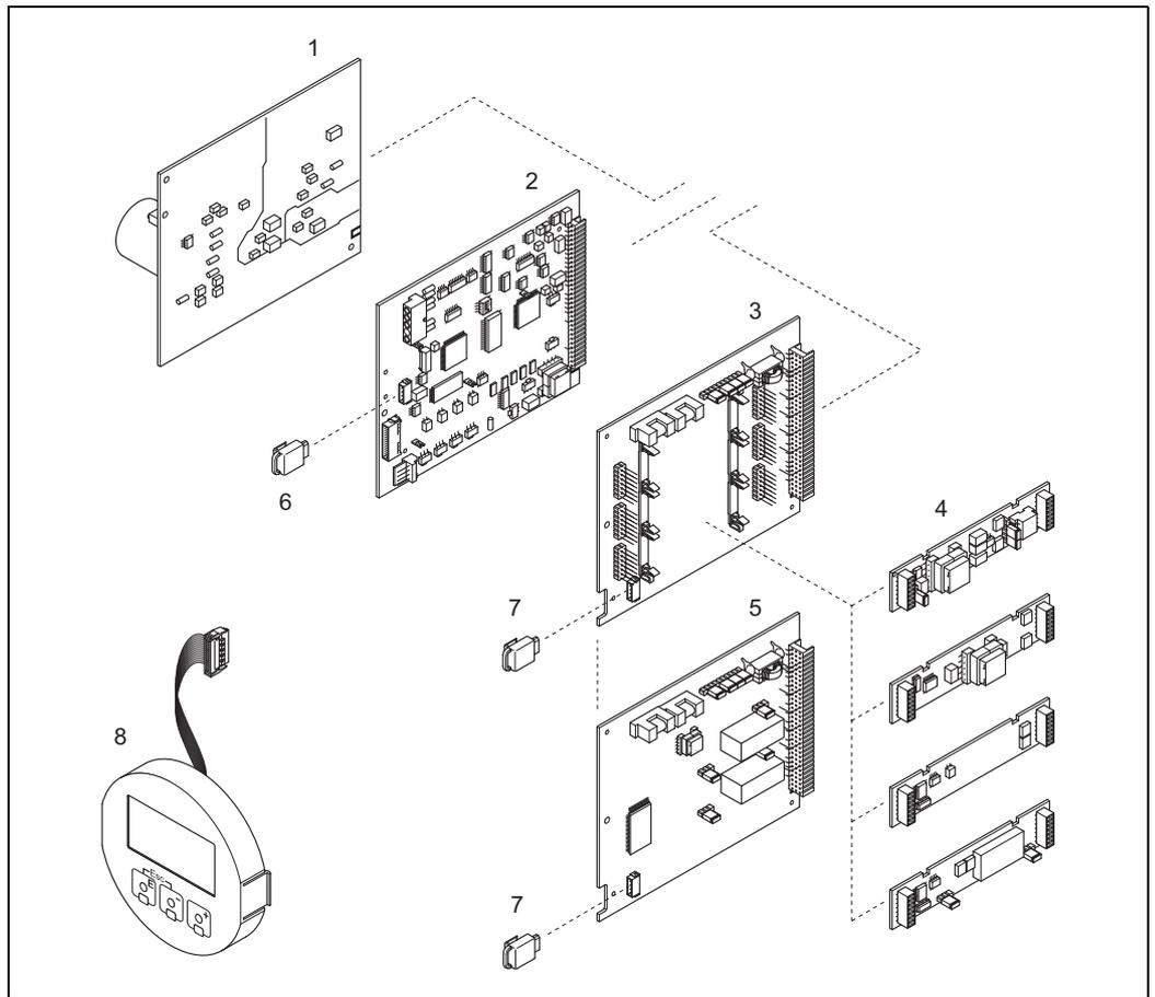
图 88: Prosonic Flow 93 变送器的备件 ( 墙装型外壳 )
