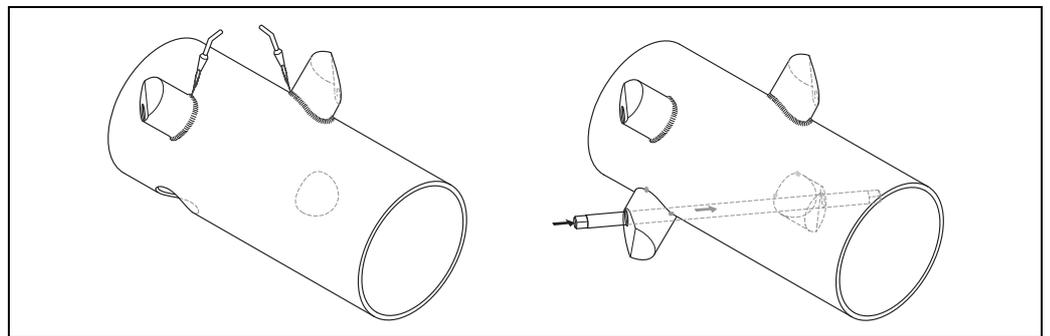
图 59: 安装双声路测量传感器，步骤 12 和 13
