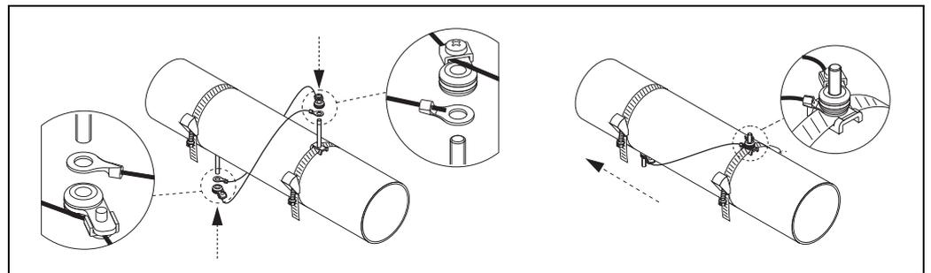
图 38: 安装捆绑带 (步骤 2...4)
