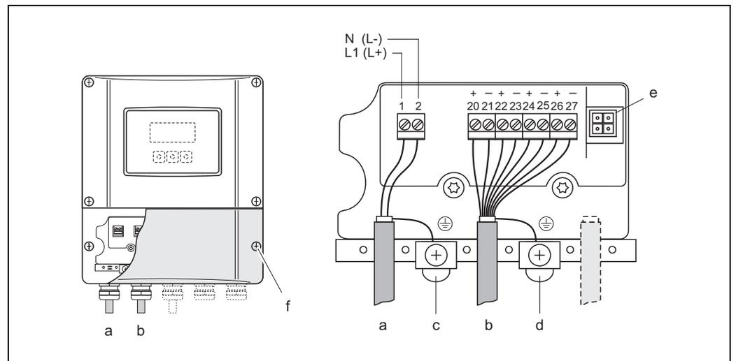
图 69: 变送器 ( 墙装型外壳 ) 的电气连接示意图，连接电缆的横截面积：max. 2.5 mm<sup>2</sup> (14 AWG)
