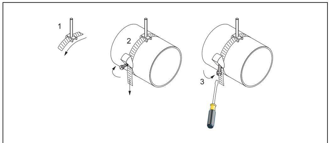
图 22: 预安装捆绑带, 适用于管道  $DN \leq 200$  (8")
