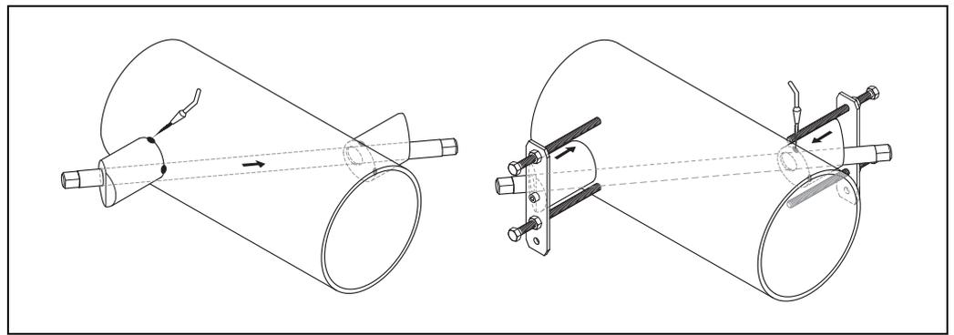
图 50: 安装测量传感器, 步骤 7 和 8
