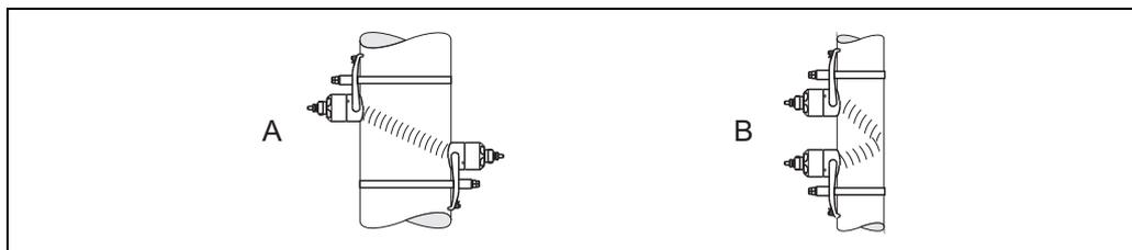
图 7: 传感器的安装位置示意图 (俯视图)
