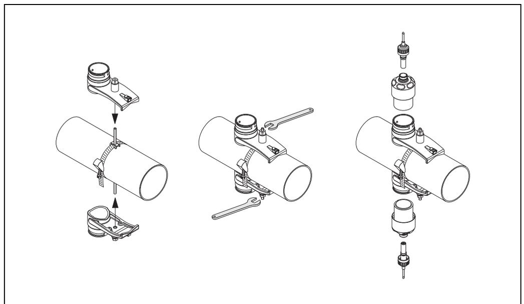
图 62: 安装声速测量传感器，步骤 1...5
