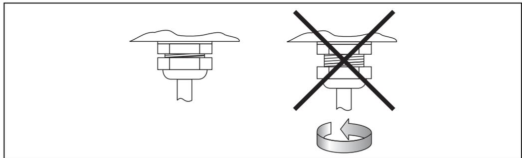
图 72: 在变送器外壳上安装电缆入口
