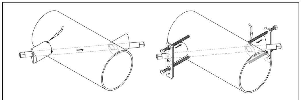
图 51: 安装测量传感器, 步骤 9 和 10
