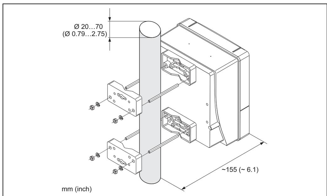
图 66: 柱式安装示意图 ( 墙装型外壳 )
