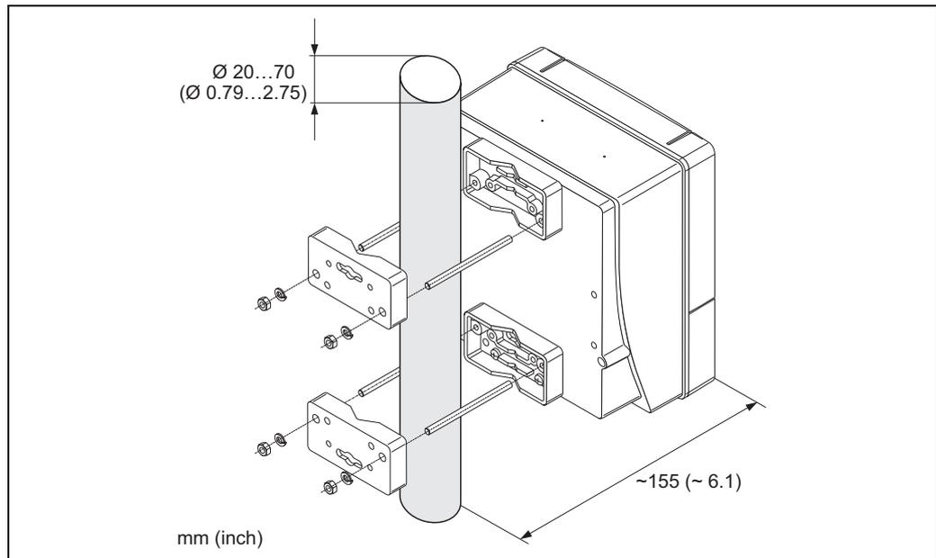
图 12: 柱式安装示意图 ( 墙装型外壳 )
