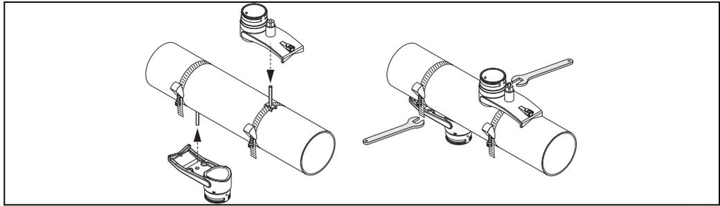
图 39: 安装传感器安装基座
