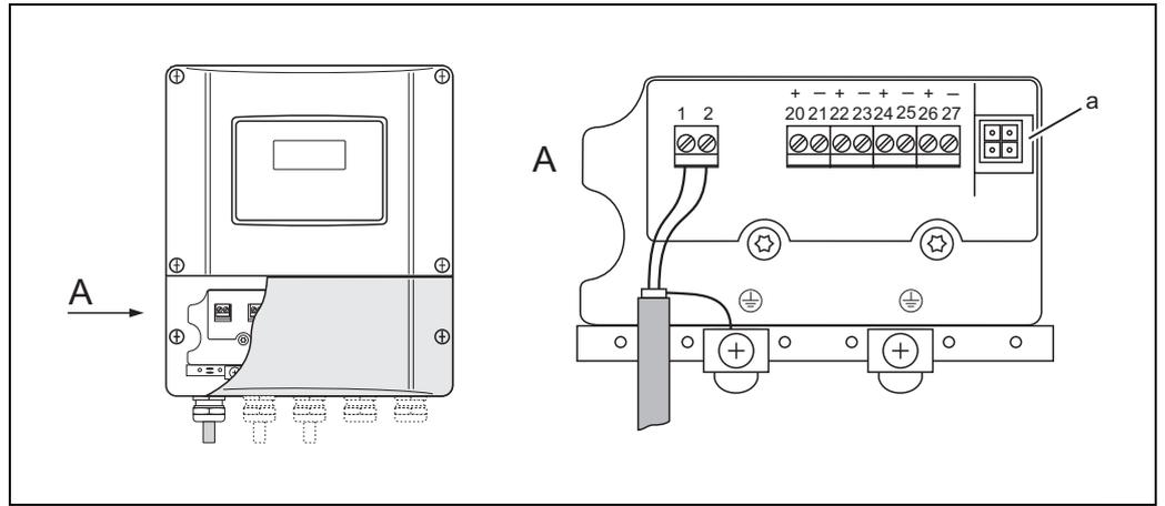
图 18: 连接安装有 FieldCare 调试工具的 PC 机
