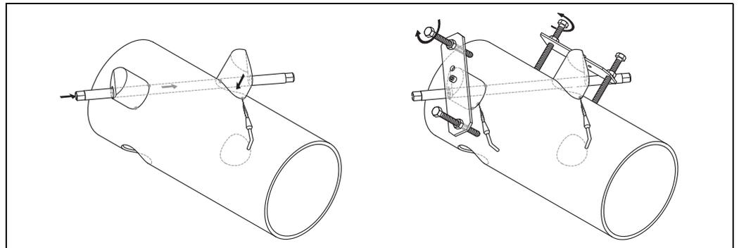
图 58: 安装双声路测量传感器，步骤 11
