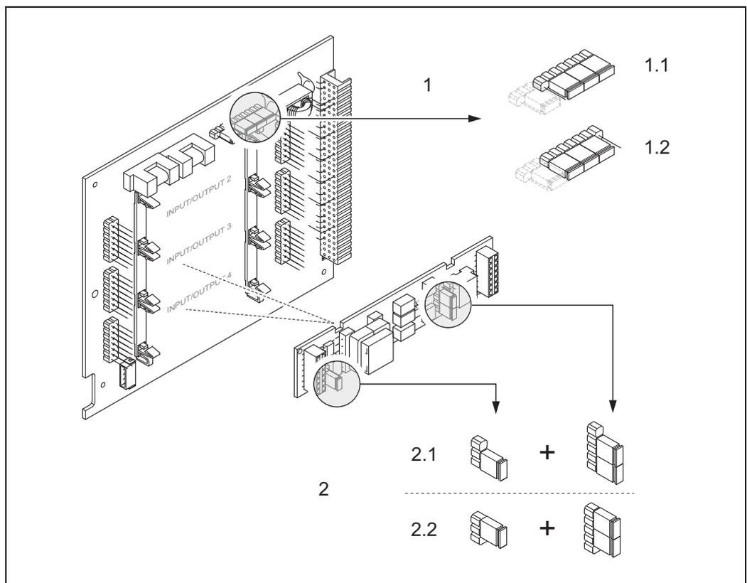
图 85: 通过跳线针 (I/O 板) 设置电流输出
