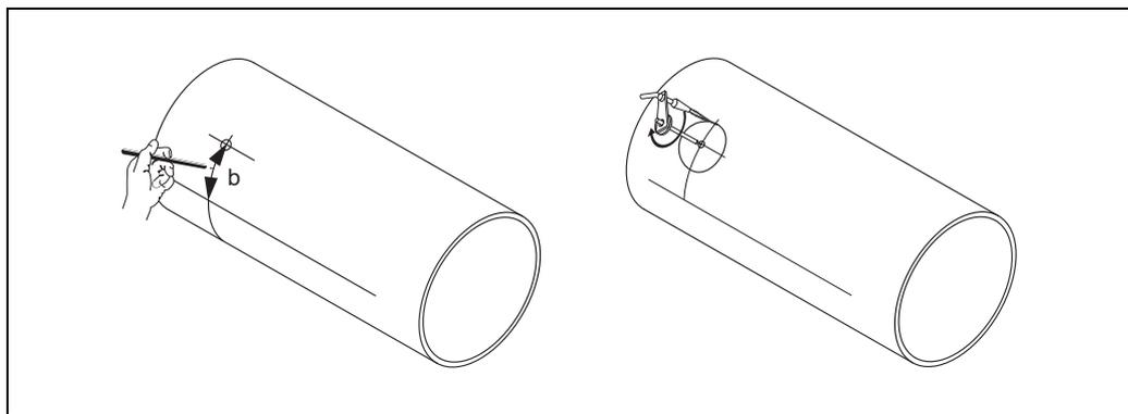
图 54: 安装双声路测量传感器, 步骤 3 和 4
