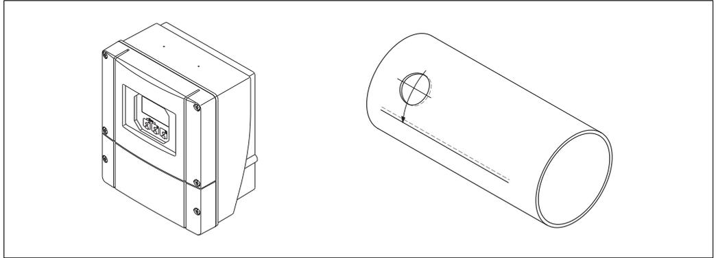
图 55: 安装双声路测量传感器, 步骤 5 和 6
