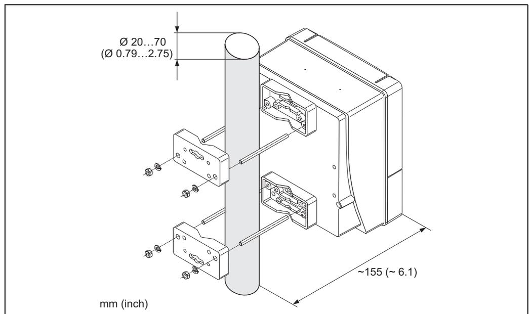
图 16: 柱式安装示意图 ( 墙装型外壳 )
