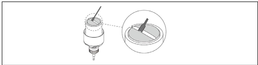
图 31: 在传感器接触表面涂上耦合剂
