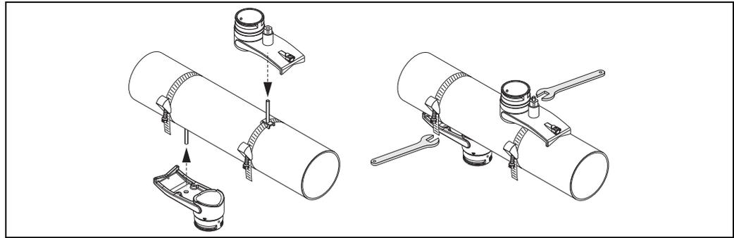
图 30: 安装传感器安装基座
