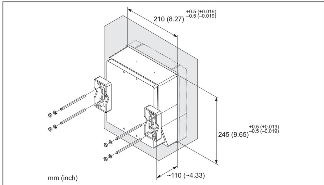
图 11: 盘式安装示意图 ( 墙装型外壳 )
