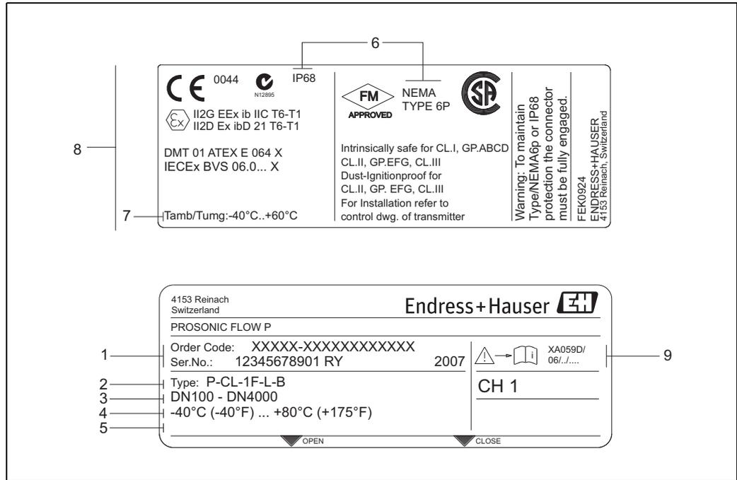
图 2: Prosonic Flow P 传感器的铭牌示意图
