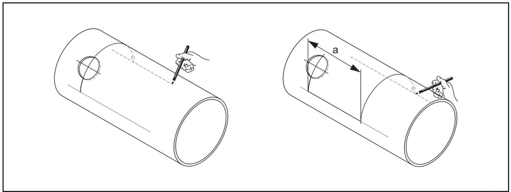
图 56: 安装双声路测量传感器, 步骤 7 和 8
