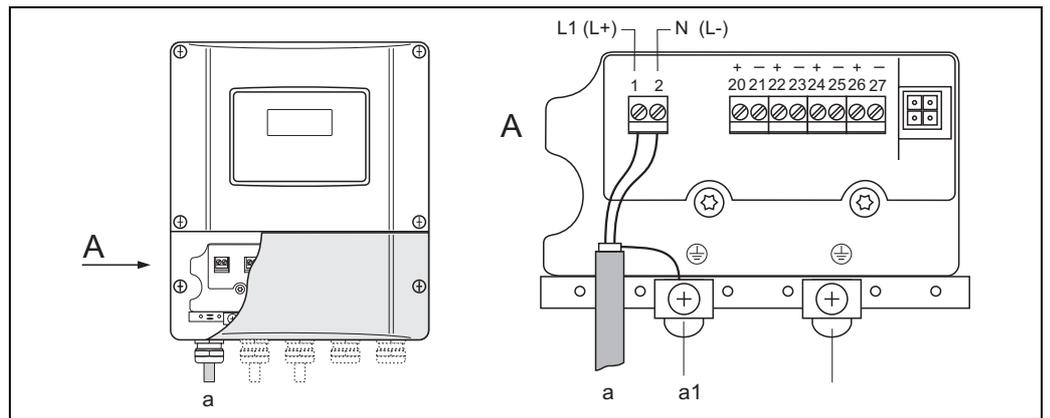
图 13: 电气连接示意图，连接电缆的横截面积: max. 2.5 mm<sup>2</sup> (14 AWG)
