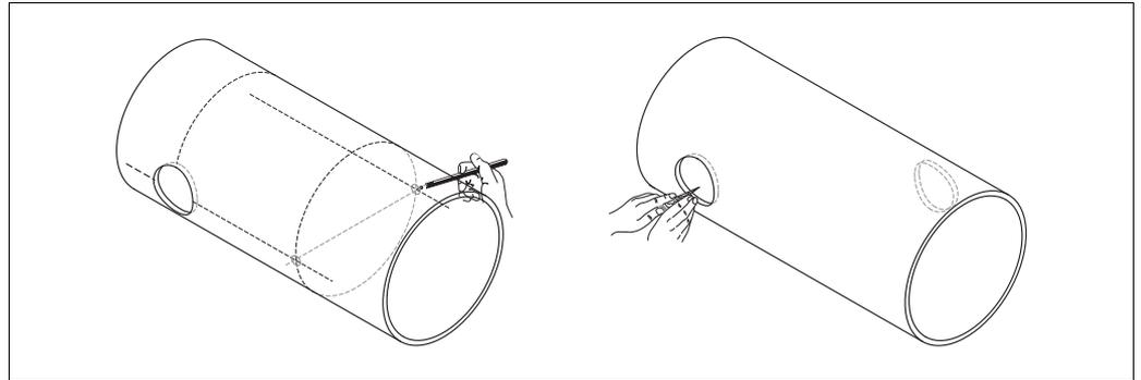
图 49: 安装测量传感器, 步骤 5 和 6
