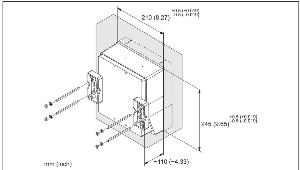
图 15: 盘式安装示意图 ( 墙装型外壳 )
