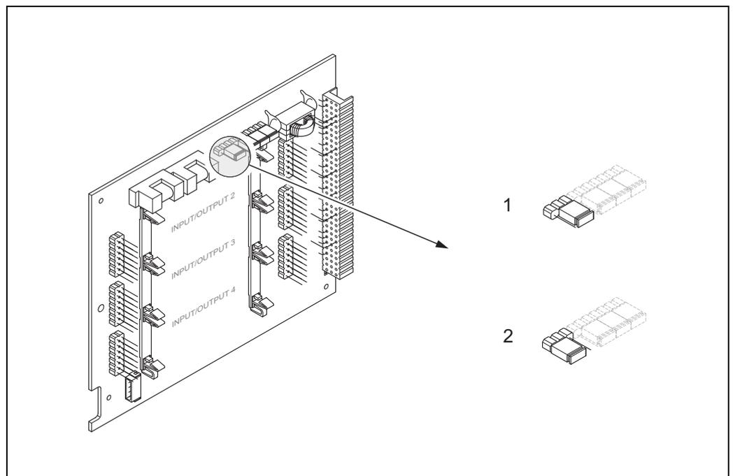
图 84: 切换 HART 写保护开 / 关 (I/O 板)
