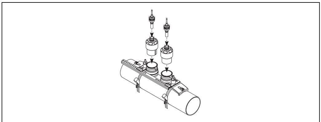
图 36: 安装传感器，连接连接电缆
