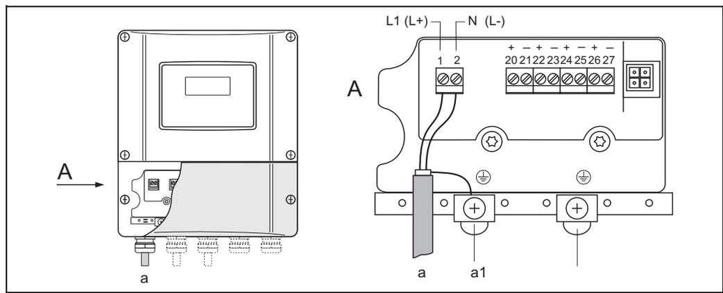
图 17: 电气连接示意图，连接电缆的横截面积：max. 2.5 mm<sup>2</sup> (14 AWG)
