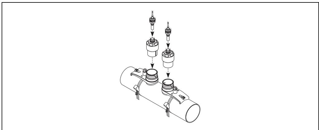
图 45: 安装传感器，连接连接电缆
