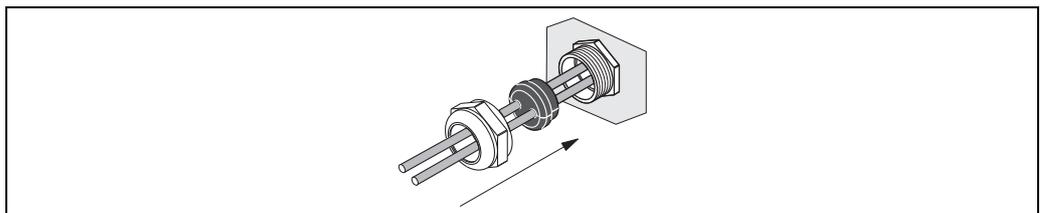
图 92: 缆塞, 每个电缆入口可以通过两根连接电缆 (2 × Ø 4 mm (0.16 in))
