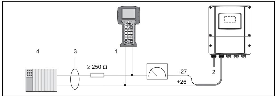
图 70: HART 手操器的电气连接示意图
