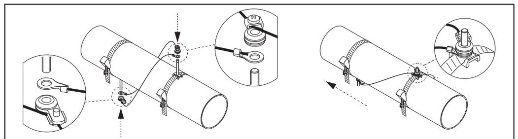
图 29: 安装捆绑带 (步骤 2...4)
