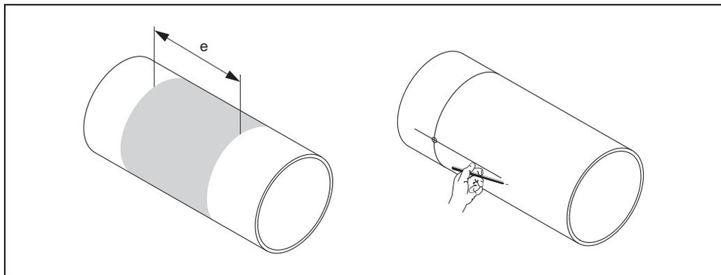
图 53: 安装双声路测量传感器, 步骤 1 和 2
