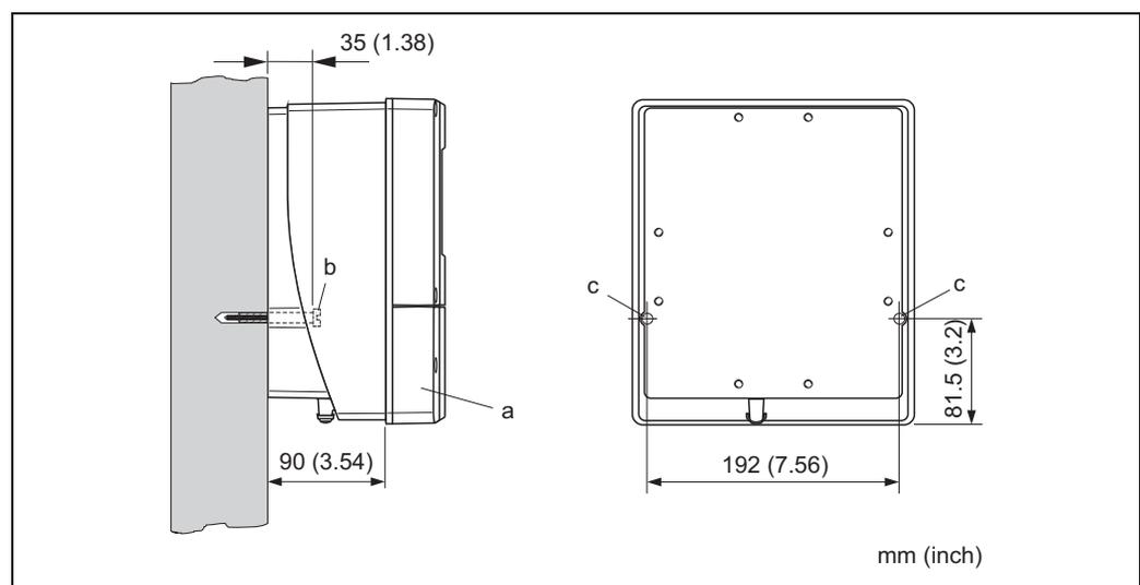
图 14: 直接安装在墙壁上
