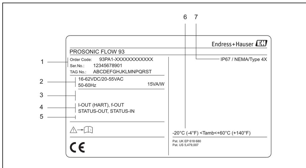
图 1: Prosonic Flow 93 变送器的铭牌示意图
