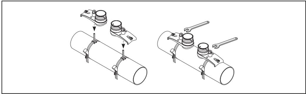
图 43: 安装传感器
