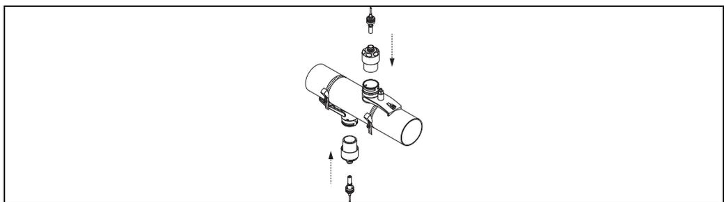
图 41: 安装传感器，连接连接电缆
