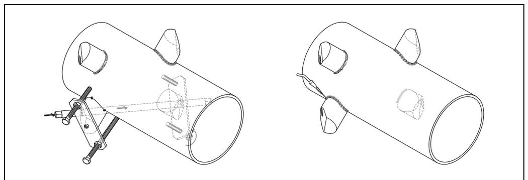
图 60: 安装双声路测量传感器，步骤 14
