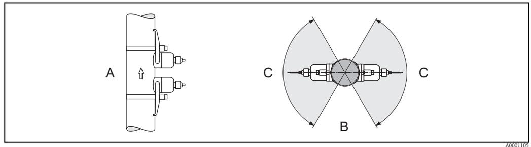
图 5: 推荐安装方向和安装角度示意图
