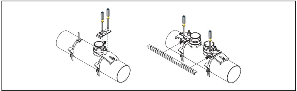
图 34: 安装传感器安装基座和安装导轨尺
