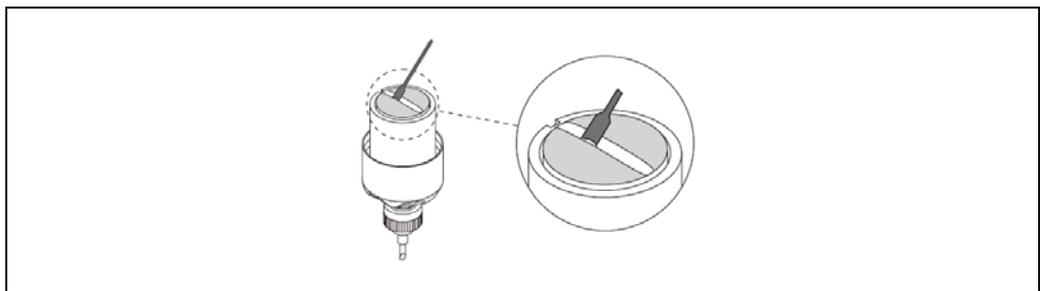
图 44: 在传感器接触表面涂上耦合剂
