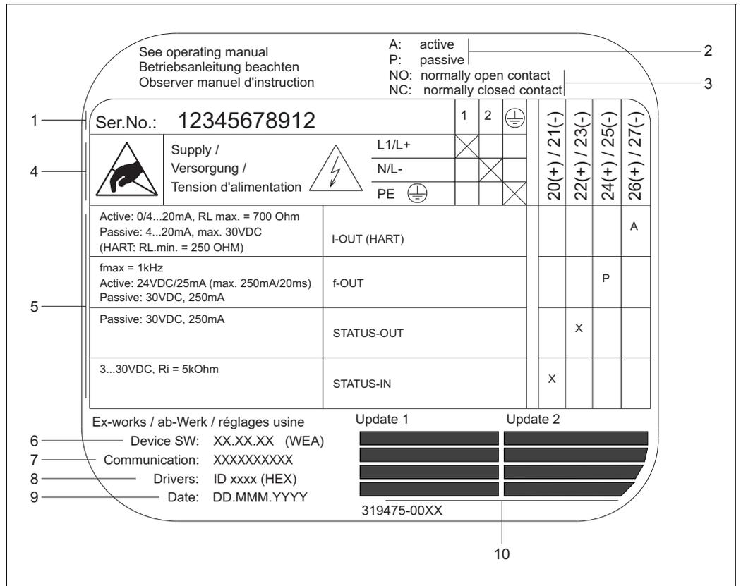
图 3: Proline 变送器的接线铭牌示意图
