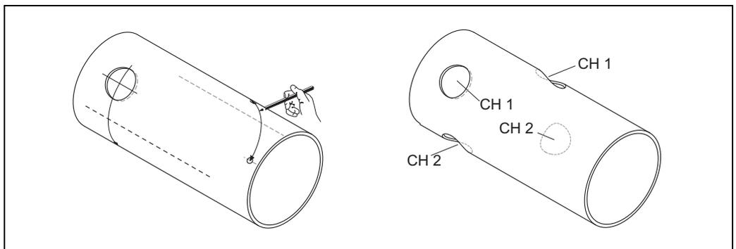
图 57: 安装双声路测量传感器, 步骤 9 和 10
