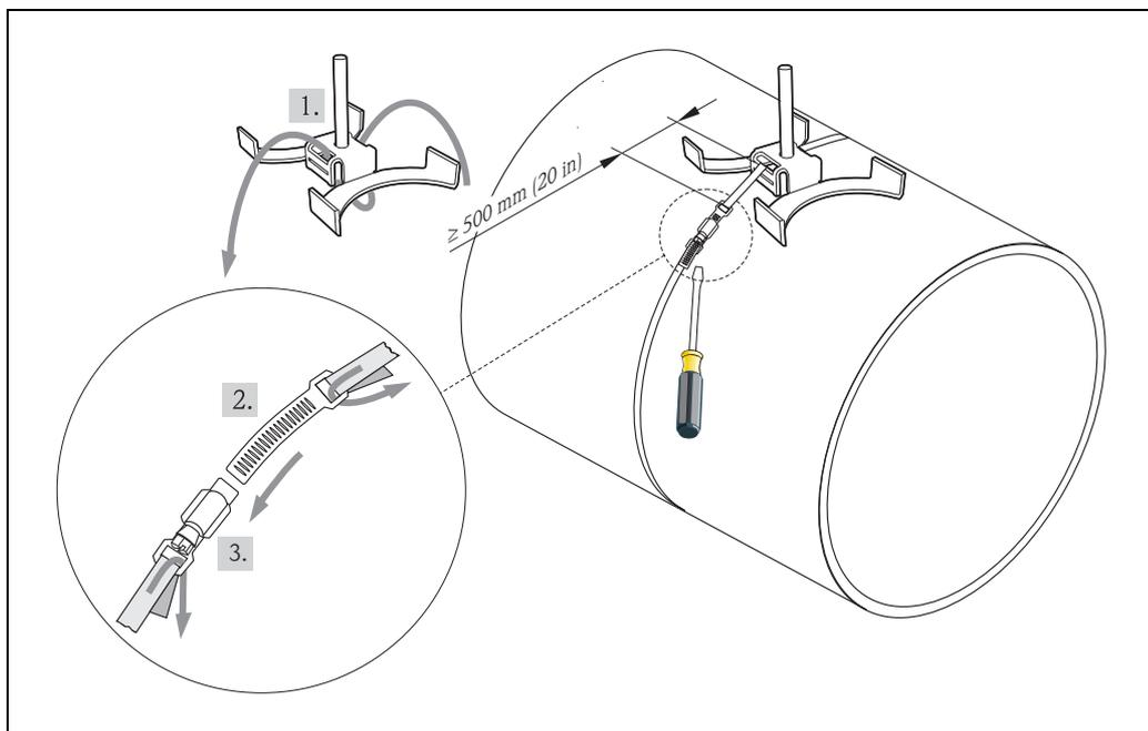
图 23: 预安装捆绑带, 适用于管道  $DN > 600$  (24")
