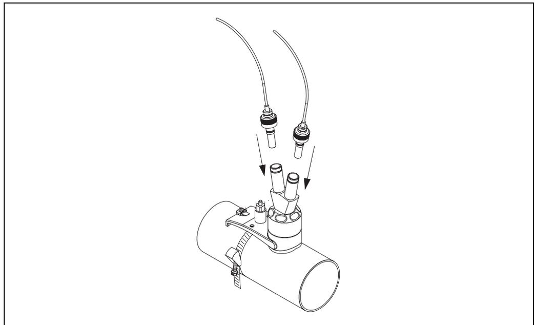
图 63: 安装壁厚测量传感器，步骤 1...5
