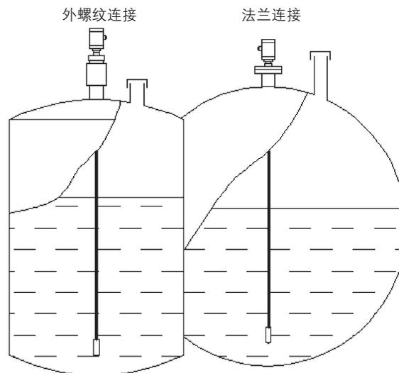
图 3 采用过程连接件安装
