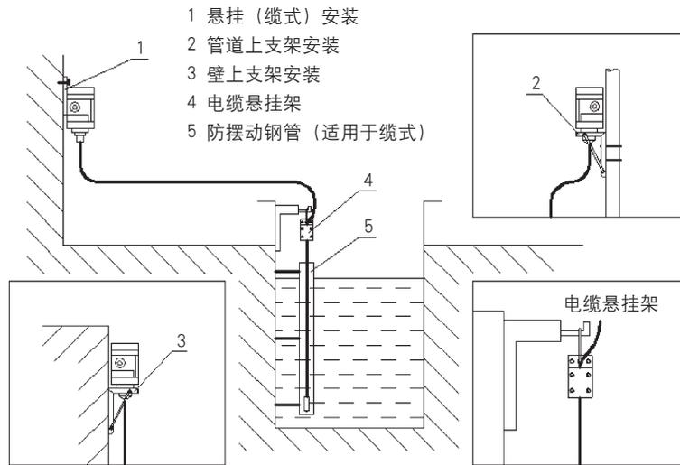
图4 采用悬挂安装或支架安装
