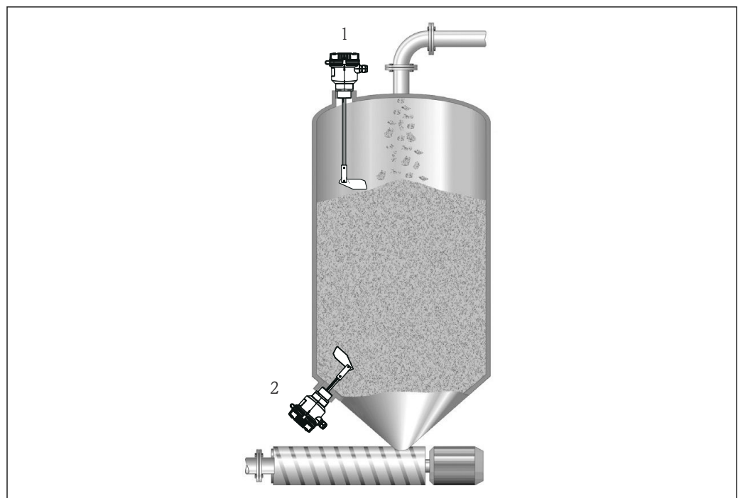
图 1 安装有 Soliswitch FTE20 的测量系统示意图
