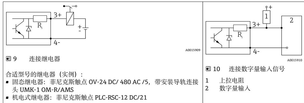
**i** 为了优化抗干扰能力，建议连接外接电阻（继电器内部阻抗或上拉电阻），电阻小于 1000 Ω。
